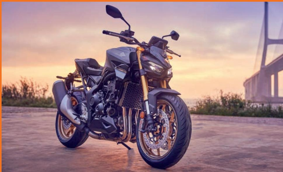
Junto con su compañera de box, la CB1000 Hornet, nuevo buque insignia naked de Honda, llega una versión SP. Equipa el mismo motor de cuatro cilindros de la CBR-1000RR Fireblade, además de una horquilla Showa SFF-BP USD de 41mm totalmente ajustable, amortiguador trasero Öhlins TTX36 trabajando a través de Pro-Link, pinzas de freno delanteras Brembo Stylema de cuatro pistones y anclaje
